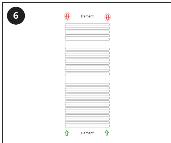
El radiador puede ser invertido para que el elemento esté posicionado en la zona inferior del radiador para que pueda instalarlo sobre la pared.
