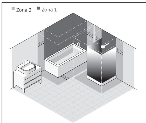
El elemento eléctrico puede ser instalado en las zonas 1, 2 y fuera de las zonas tal y como previstas por la ley aplicable, en acorde con reglamentos adicionales relacionados a instalaciones eléctricas en zonas húmedas.
