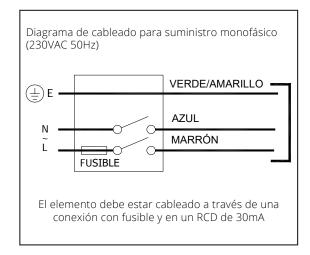
El elemento calefactor se puede instalar en baños en la zona 1, 2 y fuera de las zonas definidas por la ley aplicable, sujeto a cualquier reglamentación adicional sobre instalaciones eléctricas en áreas húmedas.
