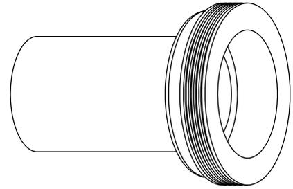
**Tubería de drenaje con anillo de sellado**
