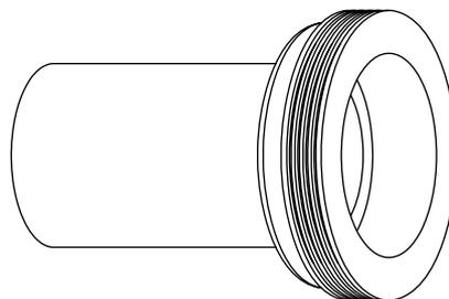
**Tubería de drenaje con anillo de sellado**
