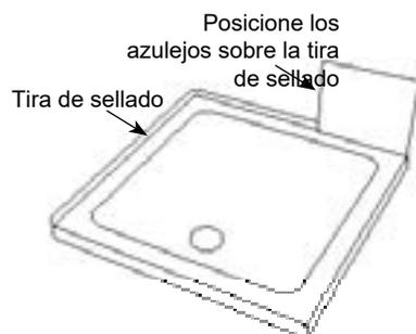
Instale el plato de ducha en la posición correcta y el alicatado delante de la tira de sellado.
