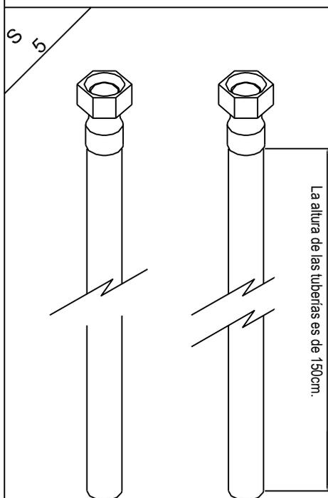
Soldar los conectores (non incluidos) a las entradas de las tuberías.
