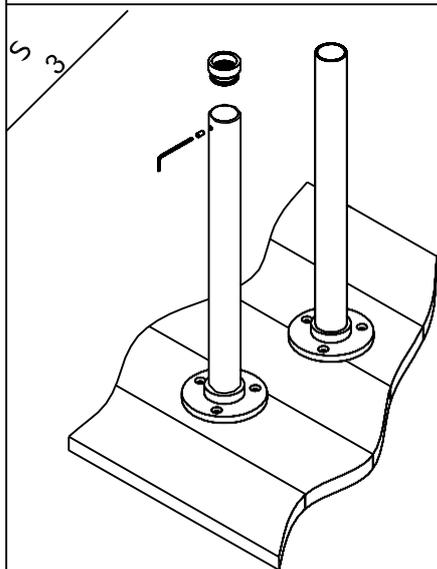
Atornille los dos cubre tuberías a las falanges. Extraiga los casquillos superiores con una llave Allen.
