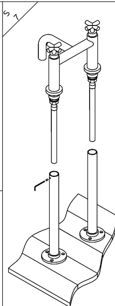
Posicione los tubos de alimentación sobre las cubre tuberías. Atornille los tornillos de varilla roscada sobre los casquillos superiores con una llave Allen.
