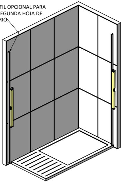
COLOQUE LOS PERFILES MURALES SOBRE EL PLATO DE DUCHA EN UNA POSICIÓN ADECUADA. VERIFIQUE QUE SEAN CORRECTO USANDO UN NIVEL DE BURBUJA Y LUEGO MARQUE A TRAVÉS DE LOS AGUJEROS DE FIJACIÓN CON UN LÁPIZ. RETIRE LOS PERFILES, LUEGO TALADRE Y AGREGUE LOS TACOS MURALES LA PARED (ART. 12). AHORA FIJE EL PERFIL DE PARED EN SU LUGAR USANDO EL ART 11.
