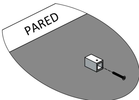
UNA VEZ MONTADO, MARQUE Y TALADRE LA ABRAZADERA MURAL DE LA BARRA SUPERIOR (ART. 5). ASEGÚRESE DE QUE LA ABRAZADERA MURAL DE LA BARRA SUPERIOR ESTÉ A NIVEL Y QUE EL TORNILLO SIN CABEZA ESTÉ ORIENTADO HACIA ARRIBA ANTES DE FIJARLO A LA PARED CON LOS ARTS. 10 Y 12.
