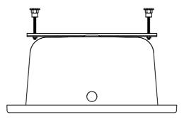
3. Ajuste la altura de las patas de la bañera para que coincida con la altura del faldón de la bañera antes de instalar la bañera.
