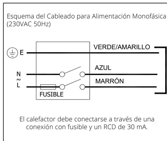
Para los calefactores equipados con un enchufe para el RU/UE, utilice una toma de corriente que esté en buen estado y correcta para el calefactor.
