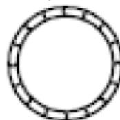
**N.B:** Las arandelas rojas deben ser montadas sobre los conectores hembra durante el montaje para asegurar obtener una conexión hermética completamente sellada.
